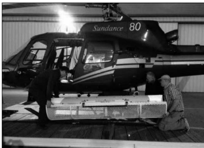
6. ábra: Kanadai légi sugárfelderítő konténer felhelyezése egy AS-350 helikopterre 13
