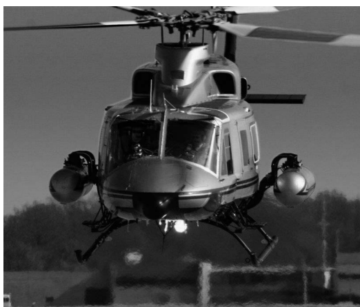
4. ábra: Az USA Atomenergia Ügynökségének légi sugárfelderítő Bell-412 helikoptere amely Fukusimában is repült. 11
