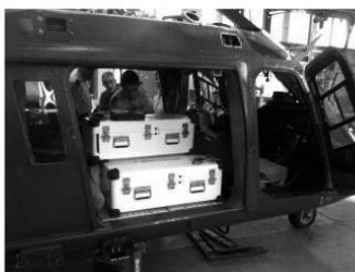
5. ábra: Belgium bőröndös kialakítású légi sugárfelderítő rendszere, amelyet egy A-109 helikopter utasterében helyeznek el. 12
